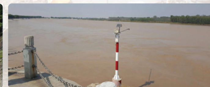
水库蓄水池水位监测
